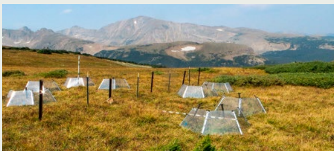
Manipulace teploty stanoviště pomocí „Open-top chambers“
